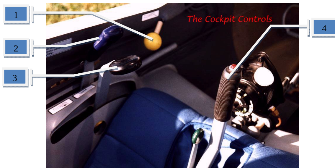
De cockpit van een ASK21, voorzien van de paraplegische hand controls.
