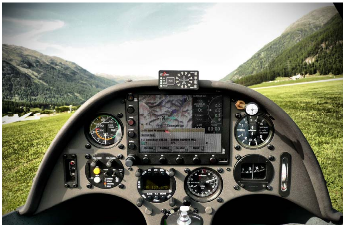
Een voorbeeld van een Duo Discus met een geavanceerde boordcomputer met moving map & GPS.
